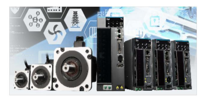
伺服系统应用较多,凡是需要精度控制的场合都离不开伺服系统。伺服系统一般由伺服驱动器和伺服电机构成,当然作为自动化设备的一部分,伺服系统还要和其他控制器(如PLC□触摸屏)等一道组成整个自动化系统。伺服控制系统有三种控制方式:定位控制、速度控制和转矩控制,其中以定位控制居多,转矩控制也常用到,而速度控制用的相对较少,是因为变频调速已经非常成熟,无论开环还是闭环,都有很好的表现,且价格比伺服系统低很多,功率又大很多,因此单独用伺服来调速的较少。看起来很普通的伺服驱动器,其实智能化程度很高,过流、过压、缺相、短路、抗干扰、自动调节等功能都具备,但有的需要通过设置启用该功能。所谓伺服调机,是指出现特殊故障,如启动转矩不足、出现共振造成输出不稳定、低速性能不理想、停机后仍然有"抖动"等不常见的故障时排除故障的一种方法或途径。
